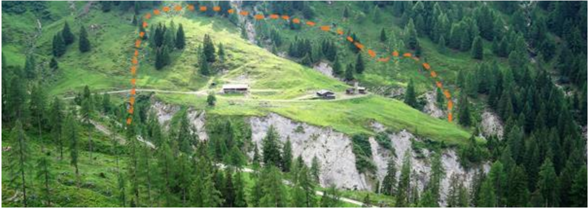
Abbildung 1-5 : Der reaktivierte Bereich der Hüttegalm in Blickrichtung Westen. Der Verlauf der im Rahmen der Begehung am 19.06.2019 beobachteten, bei der Reaktivierung am 09.06.2019 entstandenen, Risse oberhalb der Hüttegalm wurde orange markiert. Zu erkennen sind auch der unterhalb liegende Reitalmgraben im Bereich der erodierten Böschung und ein zweiter begrenzender Graben nordwestlich der Gebäude. (Valentin 2019)
