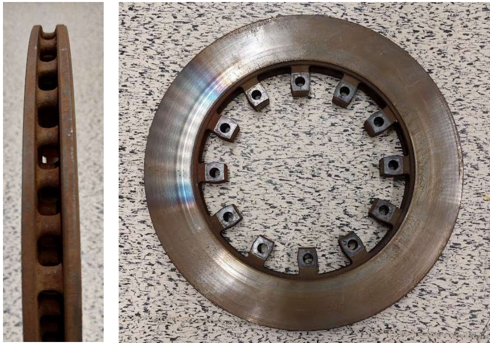
Abbildung 2-7: Aufbau einer Wellenbremsscheibe
