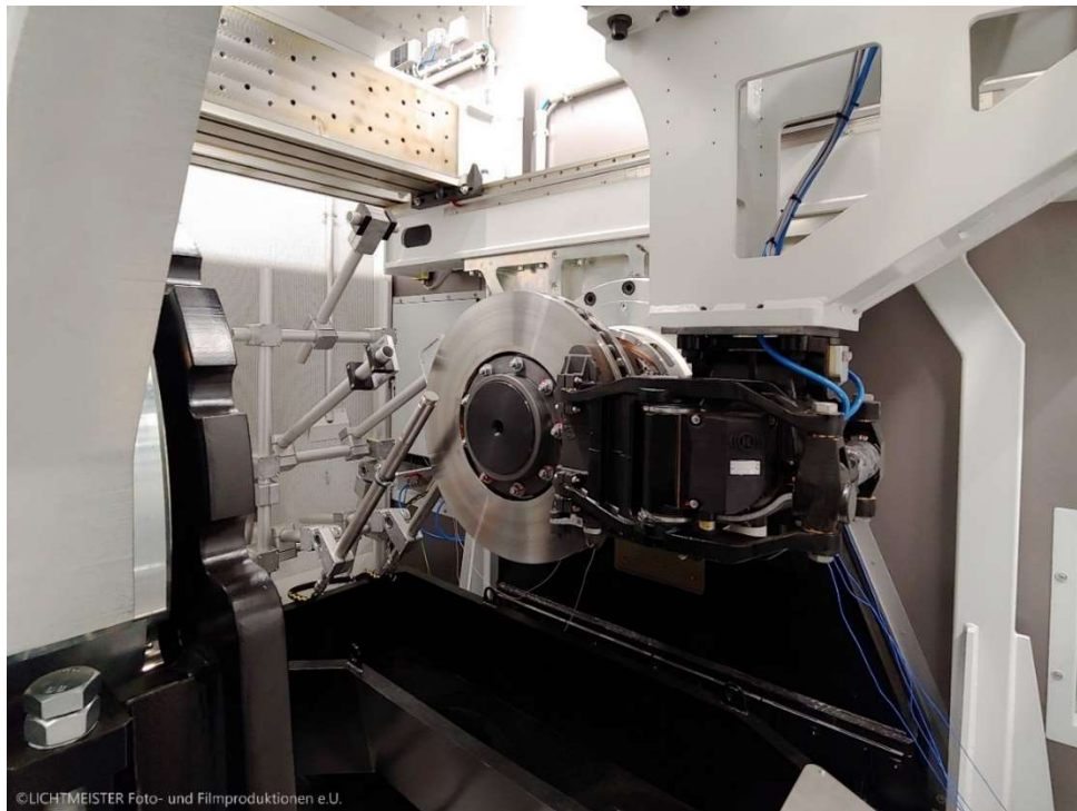
Abbildung 2-2: Wellenbremsscheibe als Kompakteinheit auf einem Prüfstand [21]
