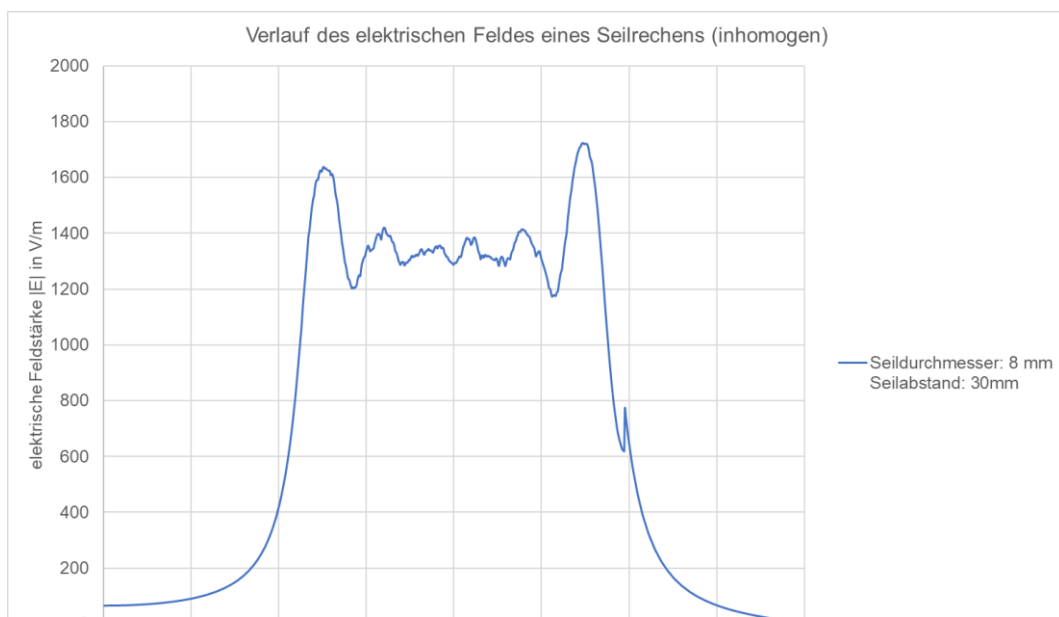
Bild 17: Diagramm der elektrischen Feldstärke in Abhängigkeit der Flusshöhe 2 cm vor dem Seilrechen mit einem Seildurchmesser von 8 mm und einem Seilabstand von 30 mm.
