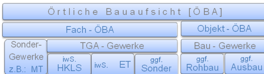
Bild 2.5 Aufbauorganisation der ÖBA bei komplexen Projekten
