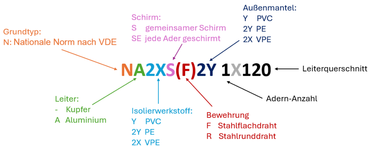
Abbildung 3 Beispielhafter Kabelbezeichnungscode mit Erklärung der Elemente
