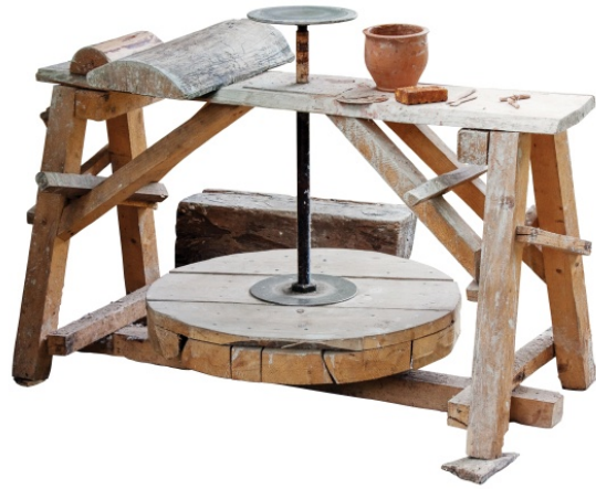
Abbildung 2.1: Einsatz eines Schwungrad-Energiespeichers in einer Töpferscheibe [8]
