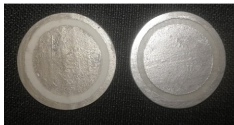
Bild 3.4: Mit Leitsilber beschichtete Plattenproben
