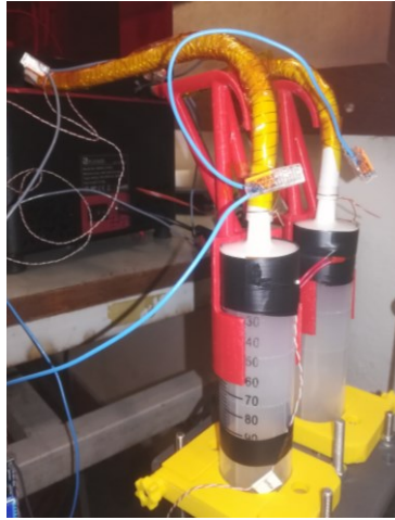
Bild 3.11: Spritzen und Verbindungsschläuche mit Heizelementen
