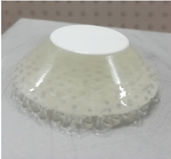
Bild 3.12: Kegelstumpf nach dem Druck auf Bauplattform mit Stützstruktur
