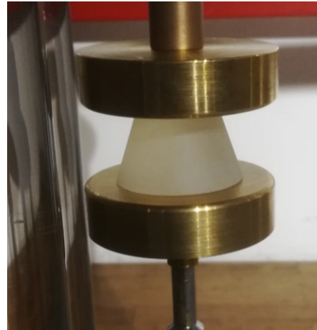
Bild 5.5: Kegelstumpfprobe zwischen Messelektroden
