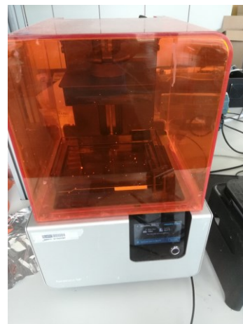
Bild 3.6: Form 1 SLA-Drucker
