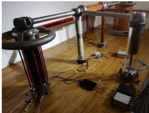
Bild 5.6: Verlustfaktormessung an Kegelstümpfen im Druckgefäß
