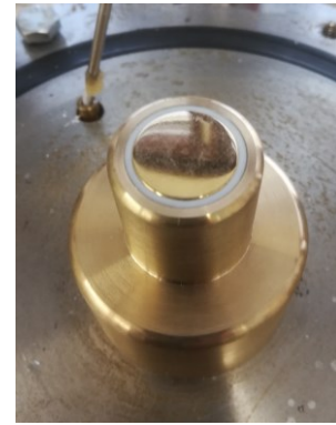
Bild 5.3: Messelektrode mit Schutzring
