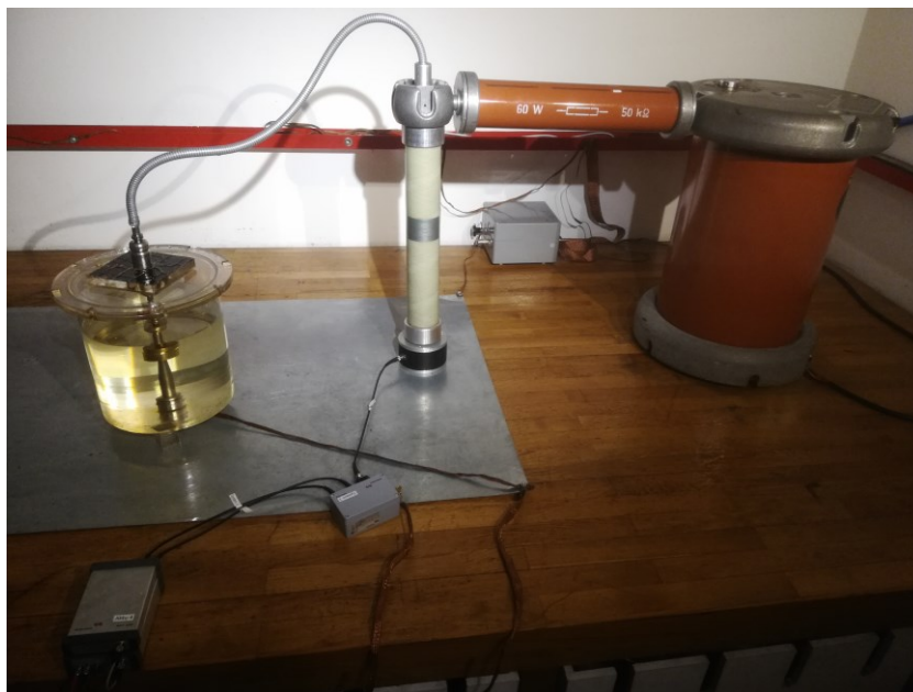
Bild 5.10: Messaufbau zur Messung der Durchschlagspannung
