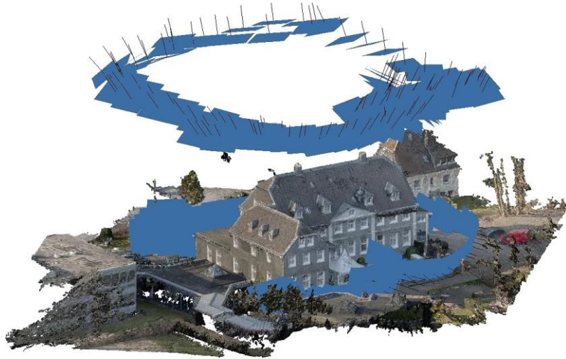
Abbildung 6.11 Erzeugung eines Modells mittels Photogrammetrie 209
