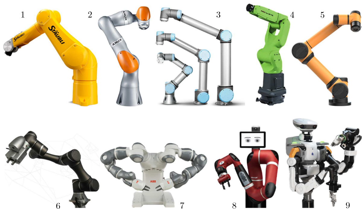
Abbildung 2.13: Kollaborationsfähige Roboter: 1. Staubli: TX2, 2. KUKA: LBR IIWA, 3. Universal Robots: UR3, UR5, UR10, 4. Fanuc: CR-35iA, 5. AUBO: OUR, 6. Techman: TM5, 7. ABB: Yumi, 8. Rethink Robotics: Sawyer, 9. Kawada: Nextage, Quelle: SAI Industrial LLC, Onlinequelle [25.07.2022] (leicht modifiziert)
