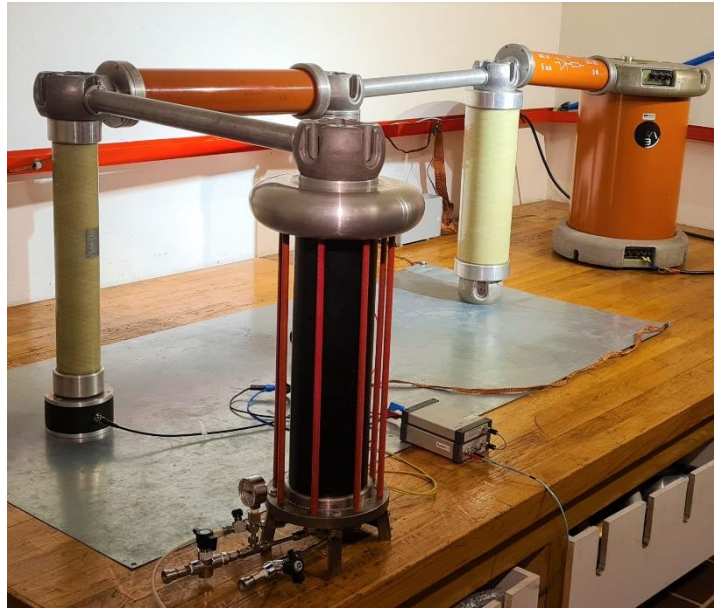
Bild 6-2: Realer Aufbau der Messschaltung im Labor mit Hochspannungstransformator, Einweggleichrichter, Glättungskondensator, ohmschem Spannungsteiler mit dem TE-Messsystem, Koppelkondensator und einer Testzelle (von rechts nach links).
