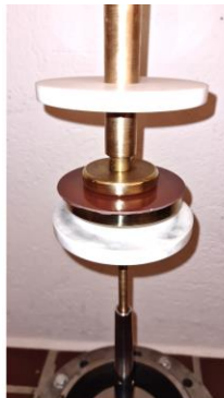
Bild 6-6: Testzellen-Anordnung für Gleitentladungen mit einer Gießharz- und Hartpapierplatte.
