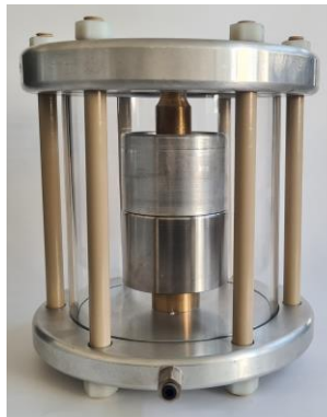
Bild 6-5: Gasisolierte Testzelle für die Messung des springenden Partikels.
