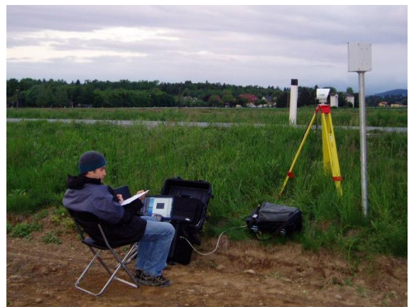
Messung Seitenradar (Geschwindigkeit) und Videodetektion (Fahrzeugzuordnung über Kennzeichen)
