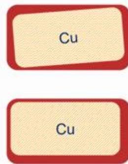
Abb. 23: Qualitätsabweichungen im Querschnitt des Kupferflachdrahtes, Quelle: MAS Firmenunterlagen.
