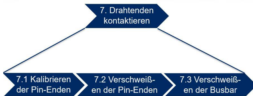
Abb. 42: Prozesskette „Drahtenden kontaktieren“, Quelle: Eigene Darstellung.
