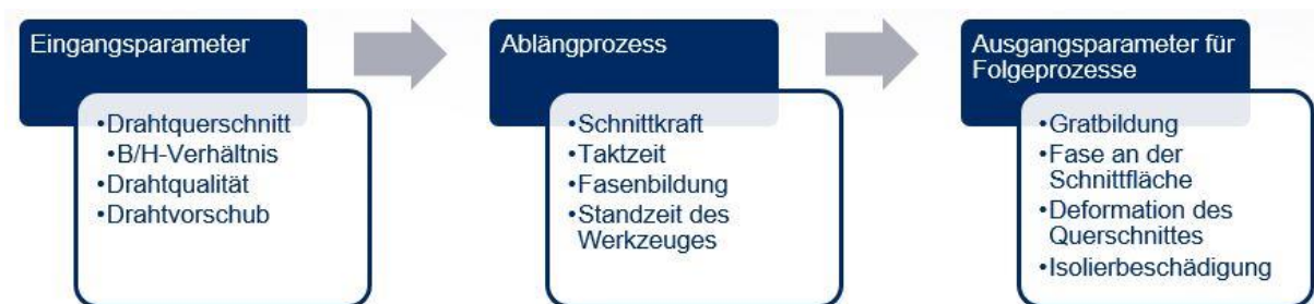
Abb. 27: SIPOC-Analyse Kupferdraht ablängen, Quelle: Eigene Darstellung.
