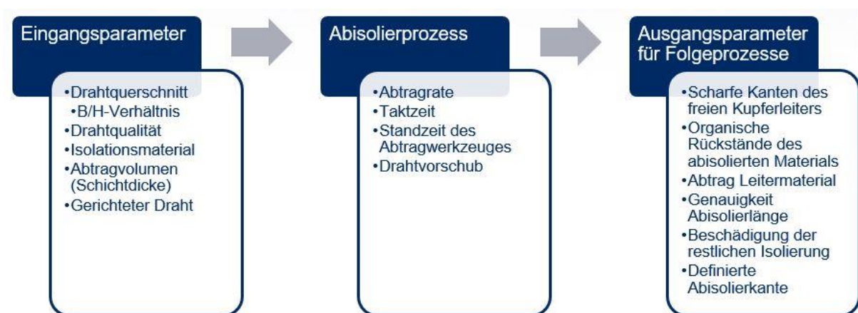
Abb. 29: SIPOC-Analyse “Kupferdraht abisolieren”, Quelle: Eigene Darstellung.
