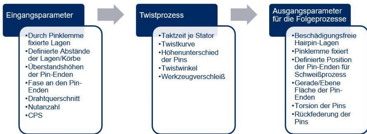
Abb. 39: SIPOC-Analyse “Drahtenden Twisten”, Quelle: Eigene Darstellung.
