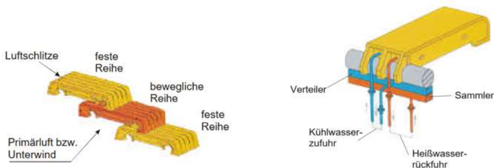
Abbildung 37: Luftgekühlter Vorschubrost (links) und wassergekühlter Roststab (rechts), aus [59].
