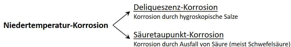
Abbildung 55: Einteilung der Niedertemperatur-Korrosion in Abfall- und Biomasseverbrennungsanlagen.
