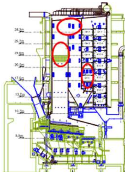
Abbildung 50: Rot markiert die Stellen mit hohem Korrosionspotential innerhalb eines Vertikalkessels, aus [44].
