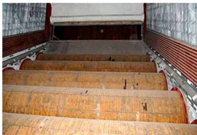
Abbildung 32: Ausführung und Betrieb eines Walzenrosts. Zusammenstellung aus Bild links [44] und Bild rechts [58].
