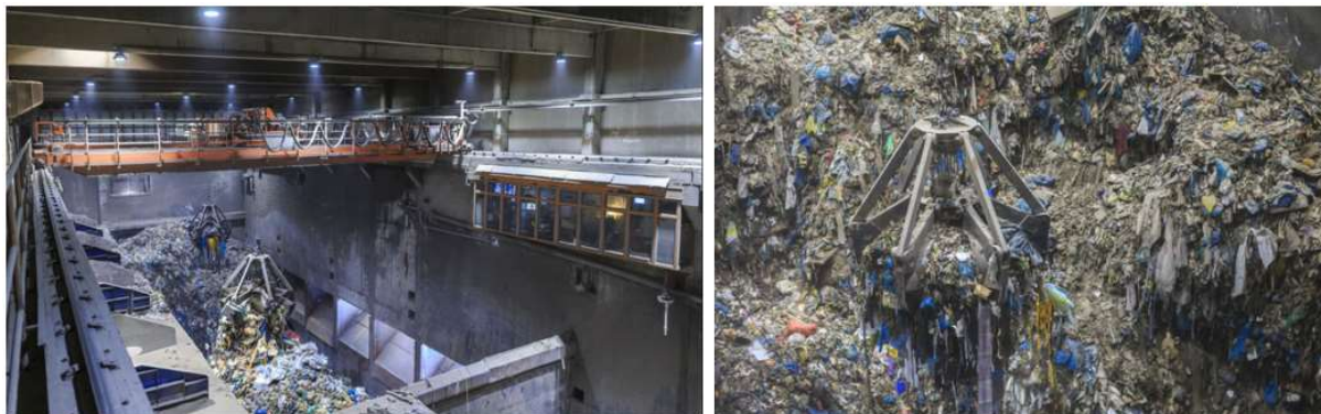
Abbildung 26: Krananlage mit Greifer zur Weiterförderung des Abfalls aus dem Müllbunker zum Aufgabetrichter in der MVA Hamm. Bildquelle [52]
