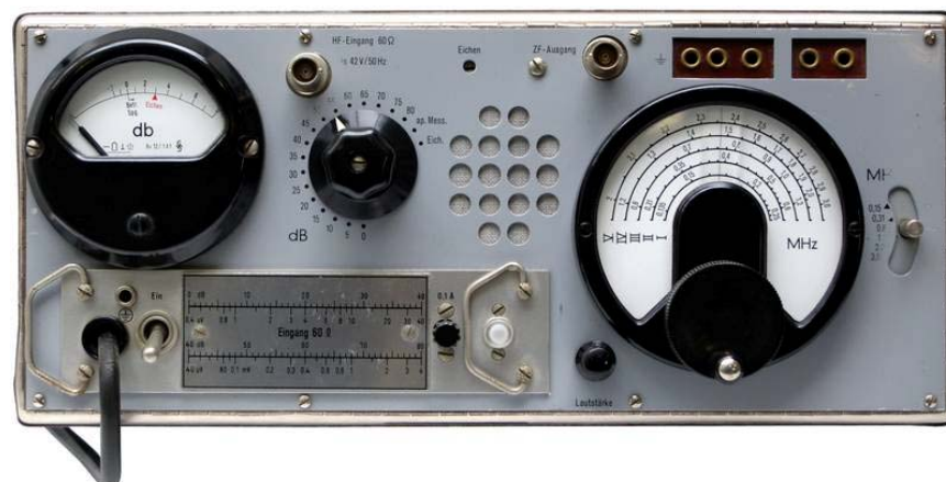
Fig. 6.2 Early instruments: Betriebs-Störmessgerät B83600-B40, Siemens, built ~1965
