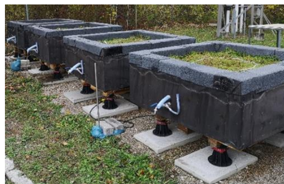
Abbildung 1: Versuchsaufbau für MCPP-Freisetzungsversuche im halbtechnischen Maßstab; Links: Verschiedene Kombinationen von Bitumenbahnen (physikalisch, chemisch) und Dachtypen (Kies, Extensiv- und Intensivbegrünung).
