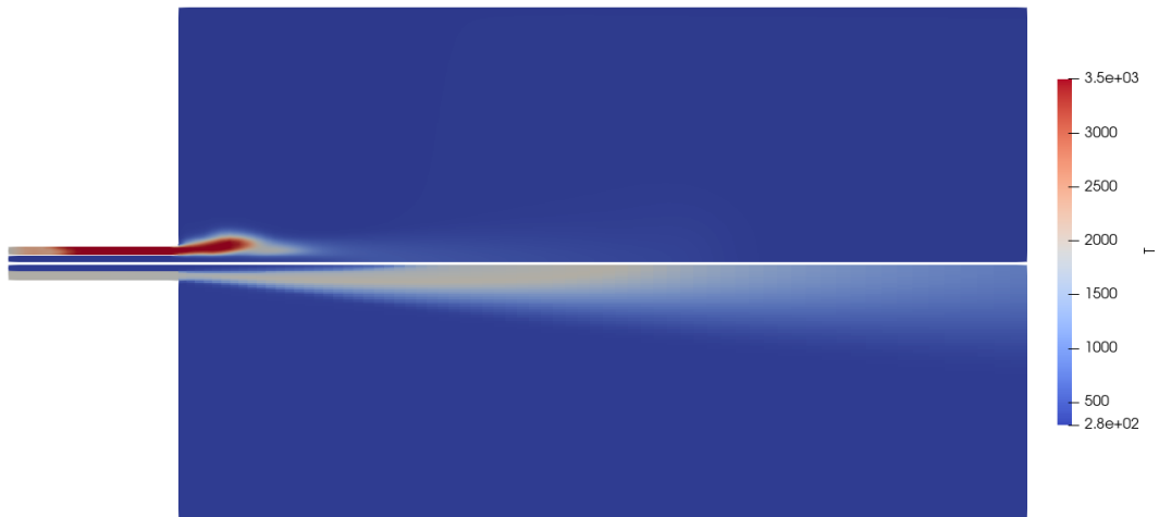
(a) Temperatur T der Flamme mit KNN-1 (oben) und SCM (unten)
