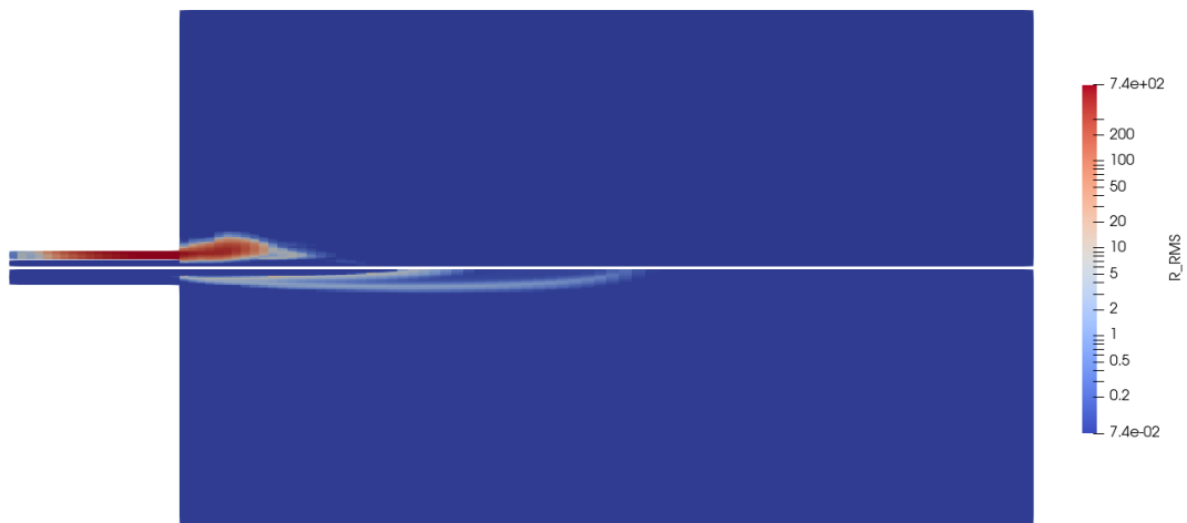
(b) RMS der Reaktionsraten R in der Flamme mit KNN-1 (oben) und SCM (unten)
