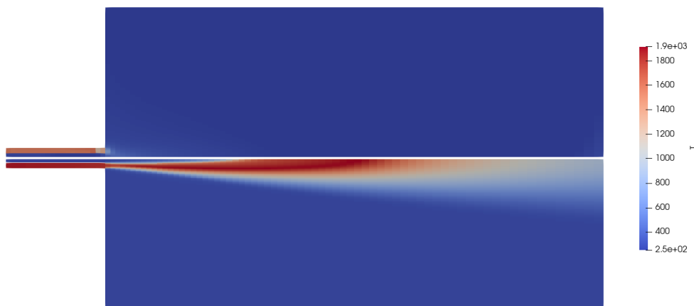
Abbildung 6.5: Vergleich der Temperaturverteilung der Sandia Flamme D berechnet mit KNN-2 (oben) und mit dem SCM (unten)
