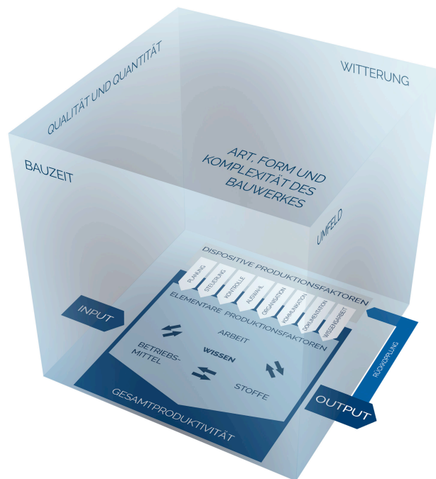
Abbildung 4: Kombination der Produktionsfaktoren im Baubetrieb – Dreidimensionales System (nach Hofstadler/Kummer 25 )
