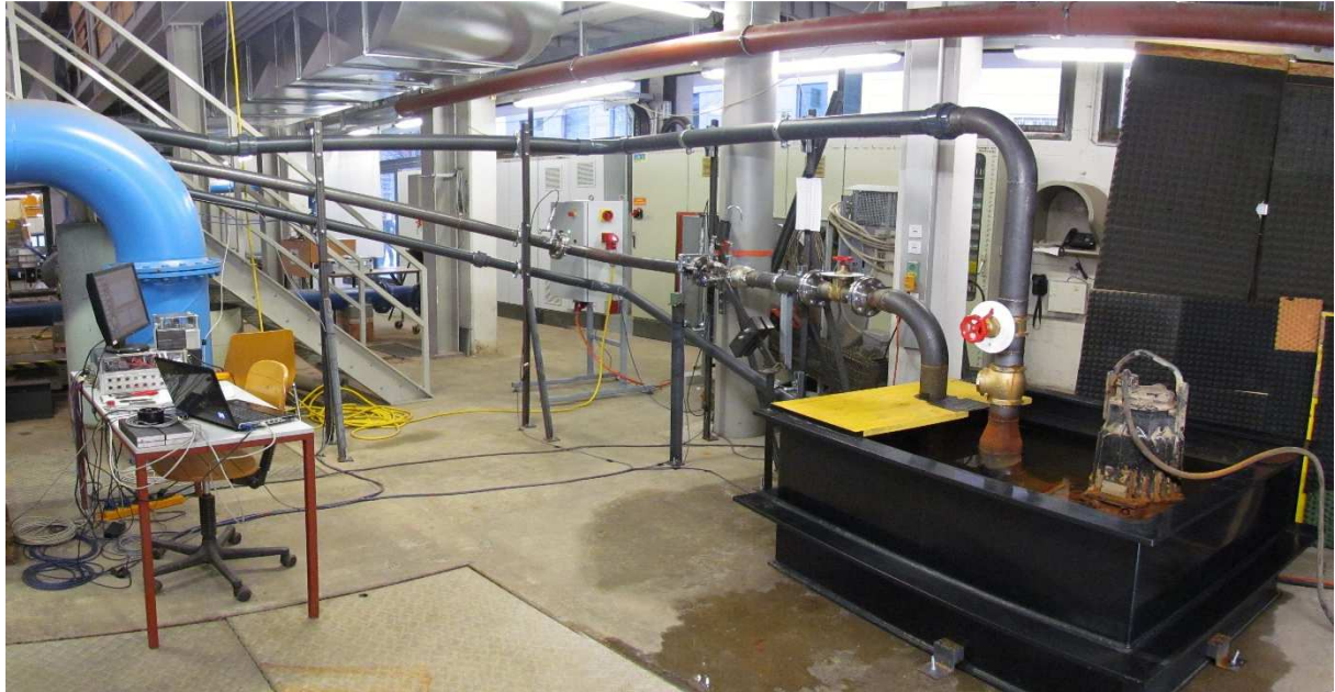
Abbildung 12.3: Unterwasserbehälter samt Pumpe, Leitungen und Messsystem
