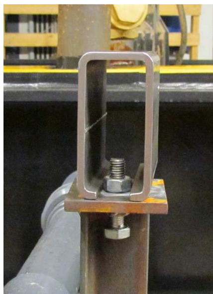
Abbildung 6.27: Zwischenanschlag des Schließgewichtes
