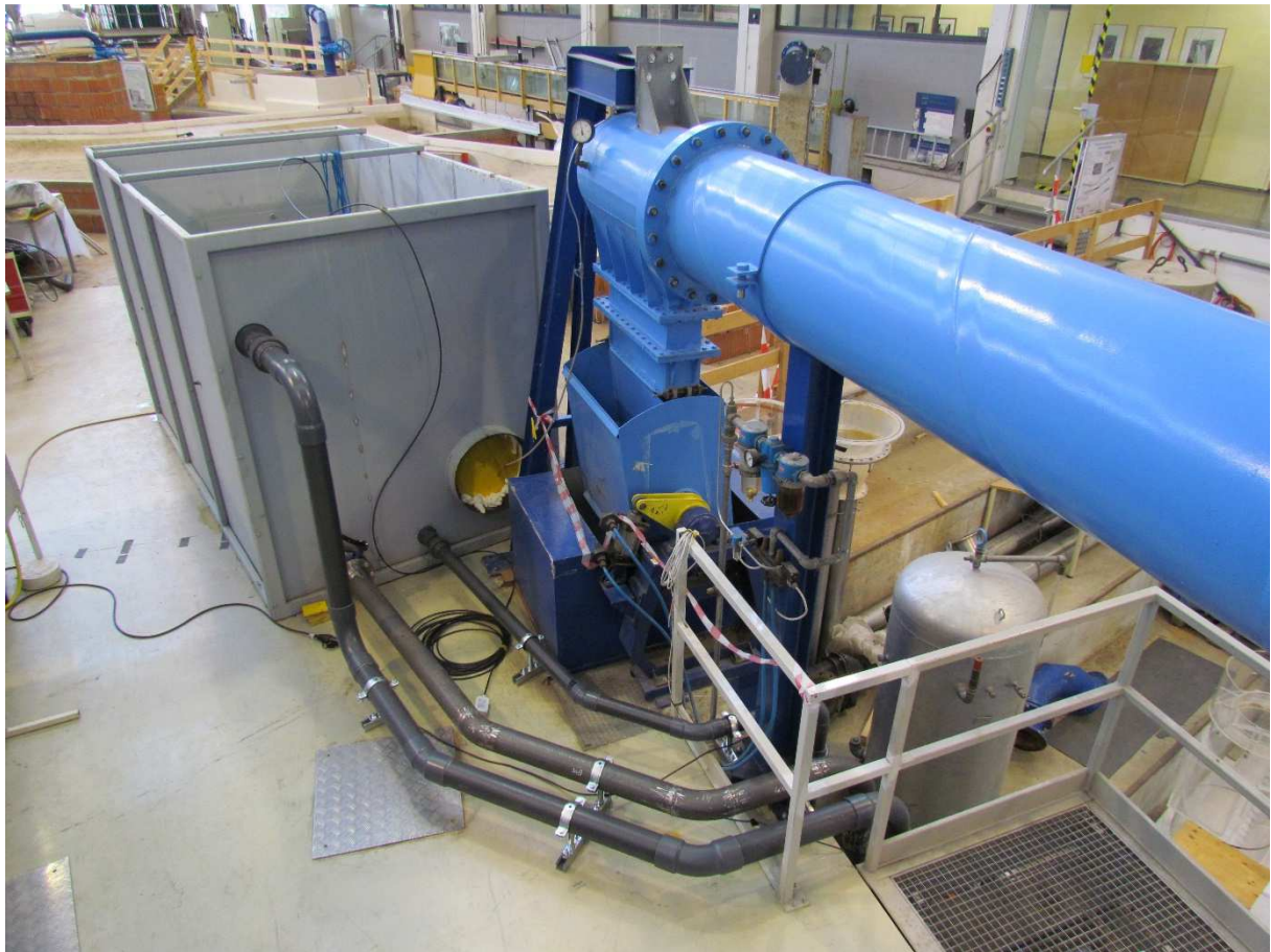
Abbildung 12.1: Oberwasserbehälter mit den drei Leitungen
