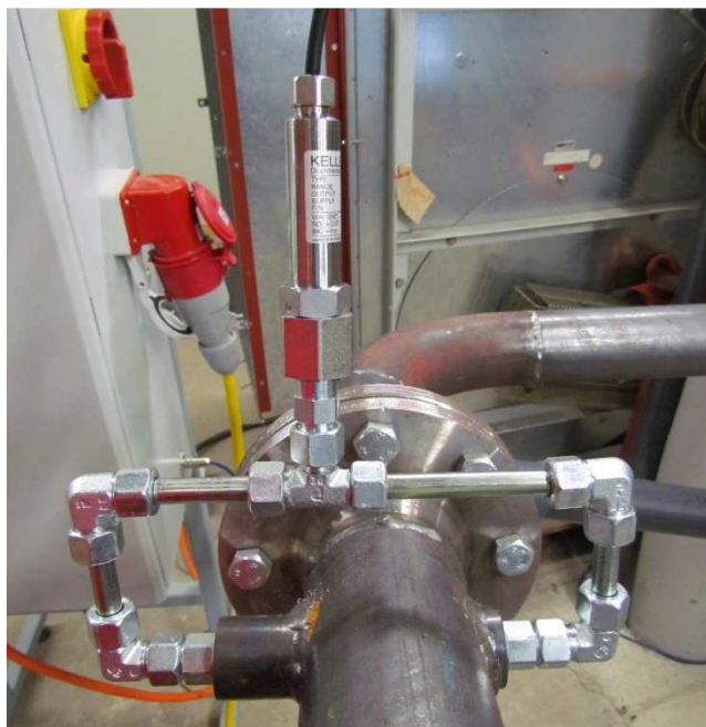
Abbildung 6.3: Messanschluss mittels Ringleitung
