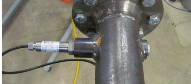
Abbildung 6.1: Messanschluss nach Norm
