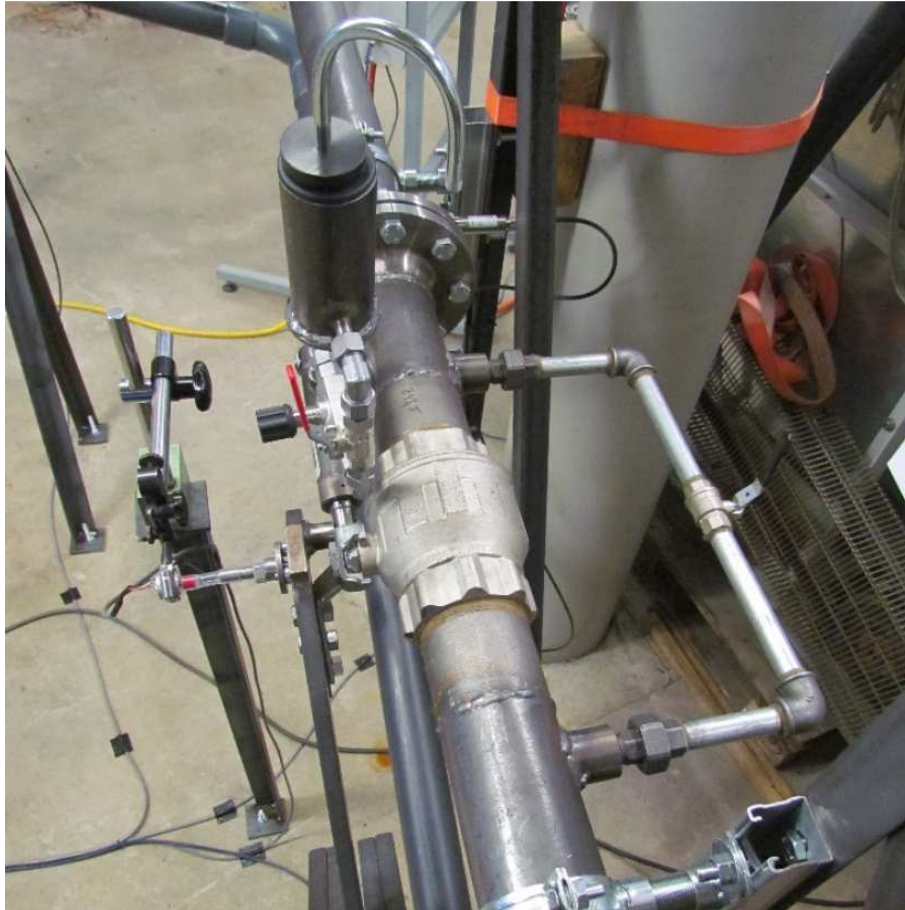
Abbildung 6.25: Absperrkugelhahn mit Bypassleitung
