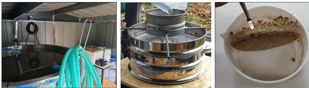
Abbildung 2: Links: Probenahmeanlage mit Feststoffsammler, programmierbarer Steuereinheit, Durchflussmessung und Überwachungskamera. Mitte: In-situ Probenaufbereitung mittels Filterkaskade (Ø 200 und 400 mm). Rechts: Sterilisierte Teilprobe nach Trocknung bei 80 °C.
