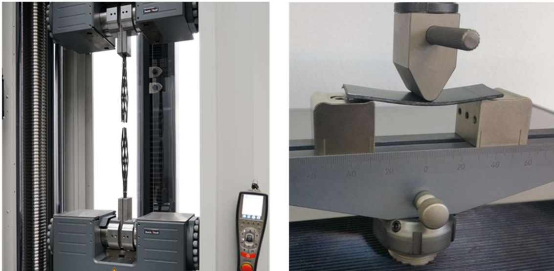
Abb. 53: Zugversuch links (Zwick/Roell, 2023) und Biegeversuch rechts (schuetz+licht, 2023)
