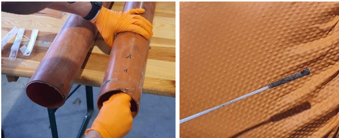
Abbildung 6-27: Durchführung eines Biofilm-Abstrichs entlang der Rohrwand (linkes Foto) und mit dem Biofilm kontaminiertes Teststäbchen (rechtes Foto) vor der L.E.S.S.-Behandlung des verkeimten TW-Rohres (Fotos: Gruber).
