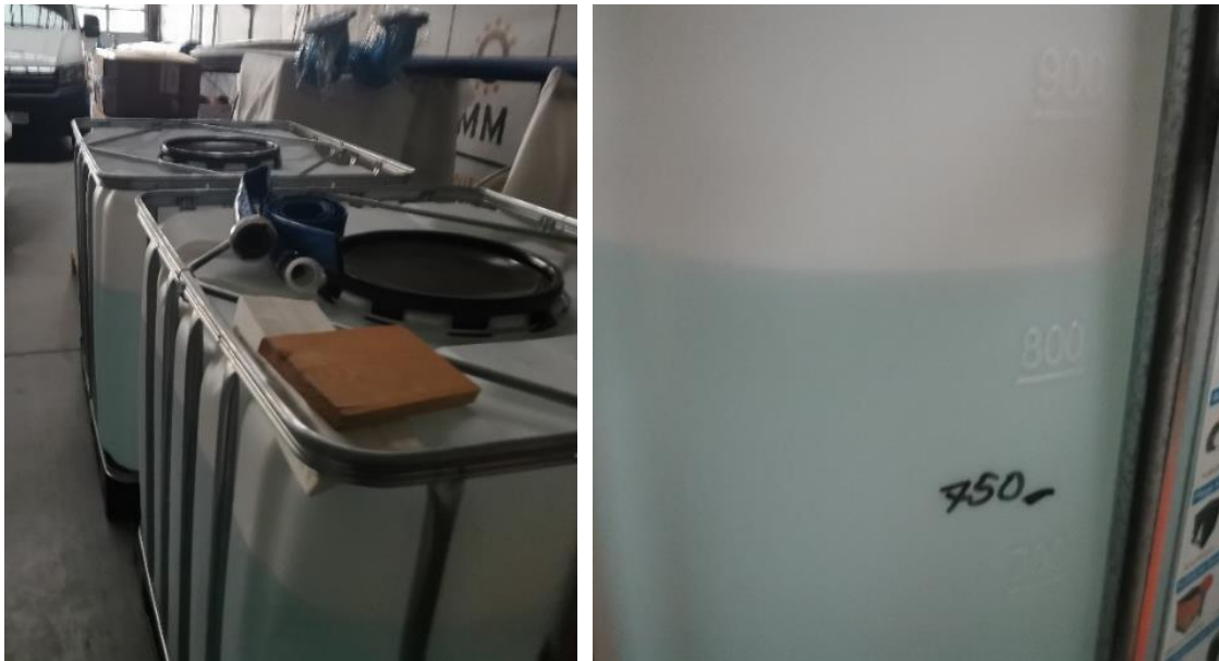
Abbildung 6-10: Behälter 1 im Vordergrund zum Auffangen der Rohrleitungsinhalte (linkes Foto) und der Füllstand im Behälter 1 nach der Zugabe von ca. 100 L Trinkwasser (rechtes Foto).
