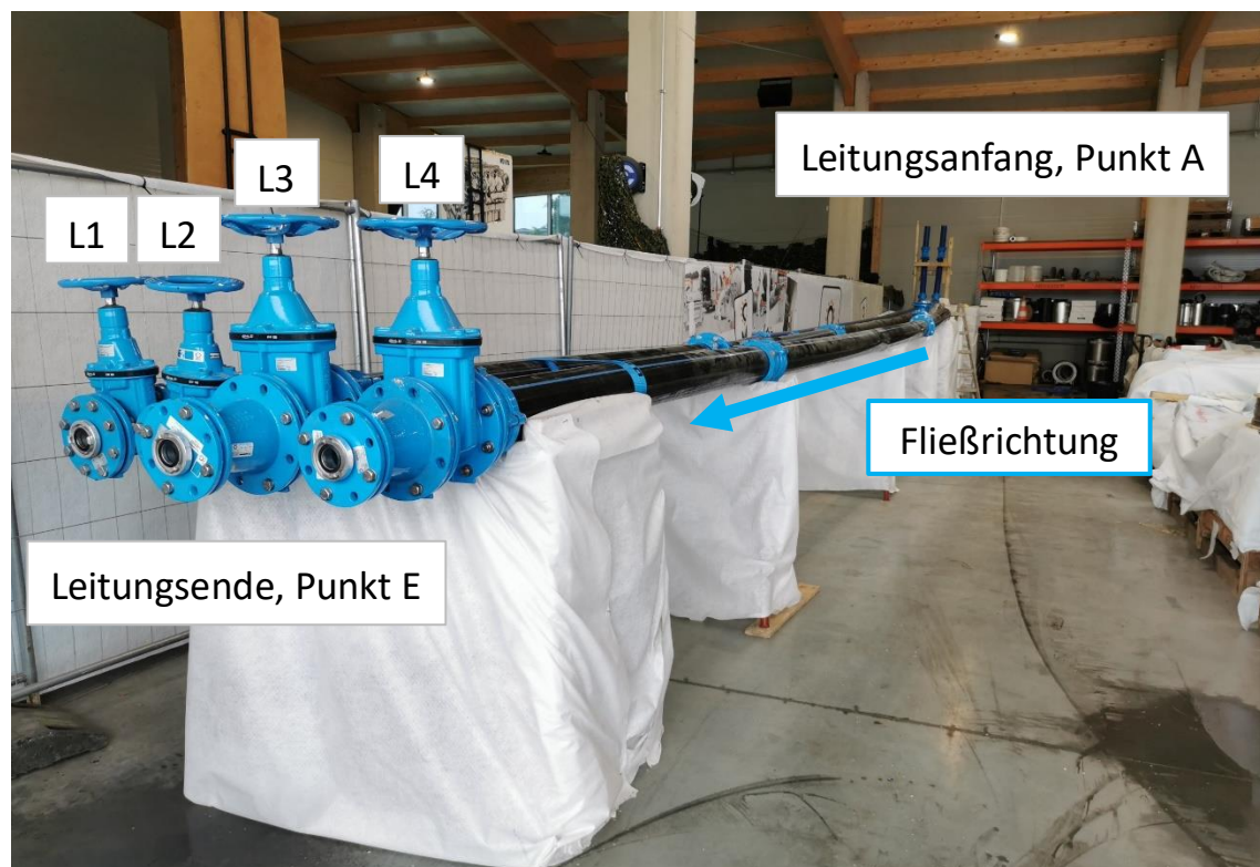
Abbildung 5-2: Versuchsaufbau der 4 Leitungen in der Werkshalle der Fa. MM Kanal-Rohr-Sanierung GmbH in Hartl.
