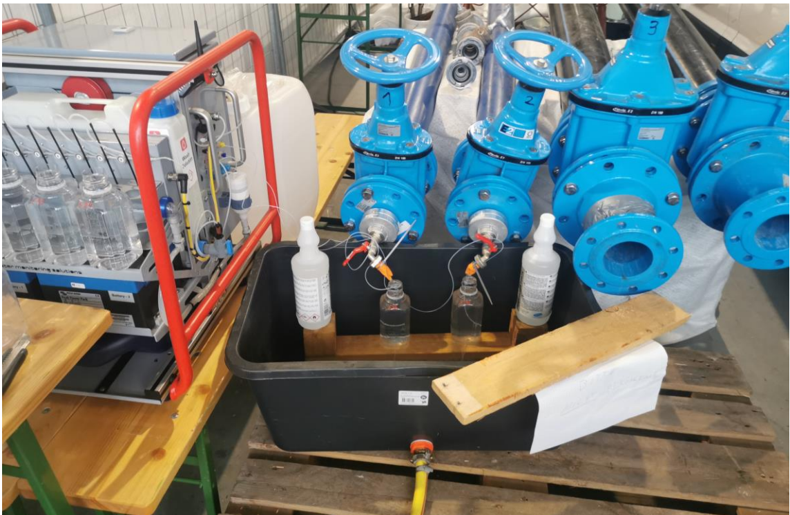
Abbildung 6-15: Versuchsaufbau für die kontinuierliche Durchflussbeschickung der beiden Leitungen 1 und 2 zur Nachbildung einer realen Betriebssituation.
