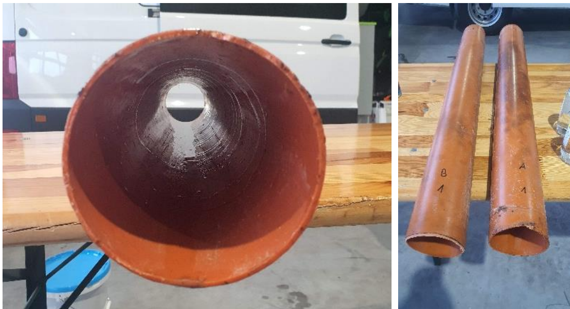
Abbildung 6-25: DN 100-Rohrquerschnitt (linkes Foto) der kontaminierten TW-Leitung und die beiden abgelängten PVC-Rohre (rechtes Foto) A und B (Fotos: Gruber).
