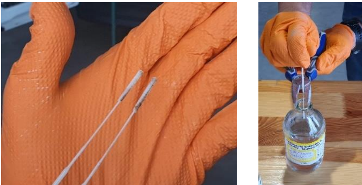
Abbildung 6-29: Mit Biofilm kontaminierte Teststäbchen nach der L.E.S.S.-Behandlung (linkes Foto) und die Teststäbchen vor dem Abschneiden (rechtes Foto) und Aufbewahrung in den sterilen und mit Kochsalzlösung befüllten Probeflaschen (Fotos: Gruber).
