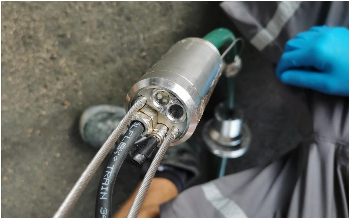
Abbildung 3-8: Installierte Kamera- und Lichteinheit am L.E.S.S. zur visuellen Kontrolle des Desinfektionsvorganges in den Rohrleitungen.
