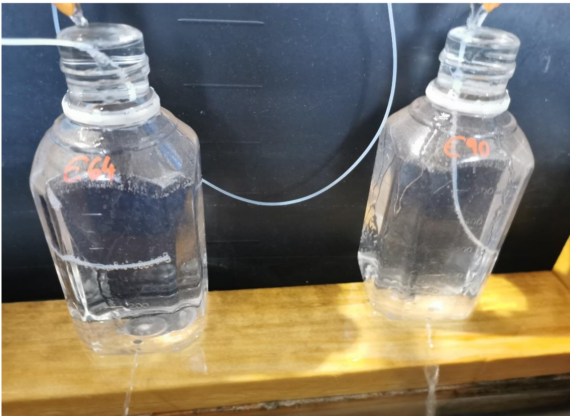
Abbildung 6-16: Probeflaschen mit Grundablass und Überlauf für die kontinuierliche Probenahme durch den ColiMinder.
