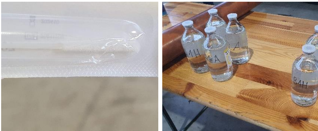
Abbildung 6-26: Sterile Teststäbchen (linkes Foto), die auch für die Corona-PCR-Tests verwendet werden und die sterile und mit 0,9%iger Kochsalzlösung befüllte Probeflaschen (rechtes Foto) für die Biofilm-Untersuchungen (Fotos: Gruber).
