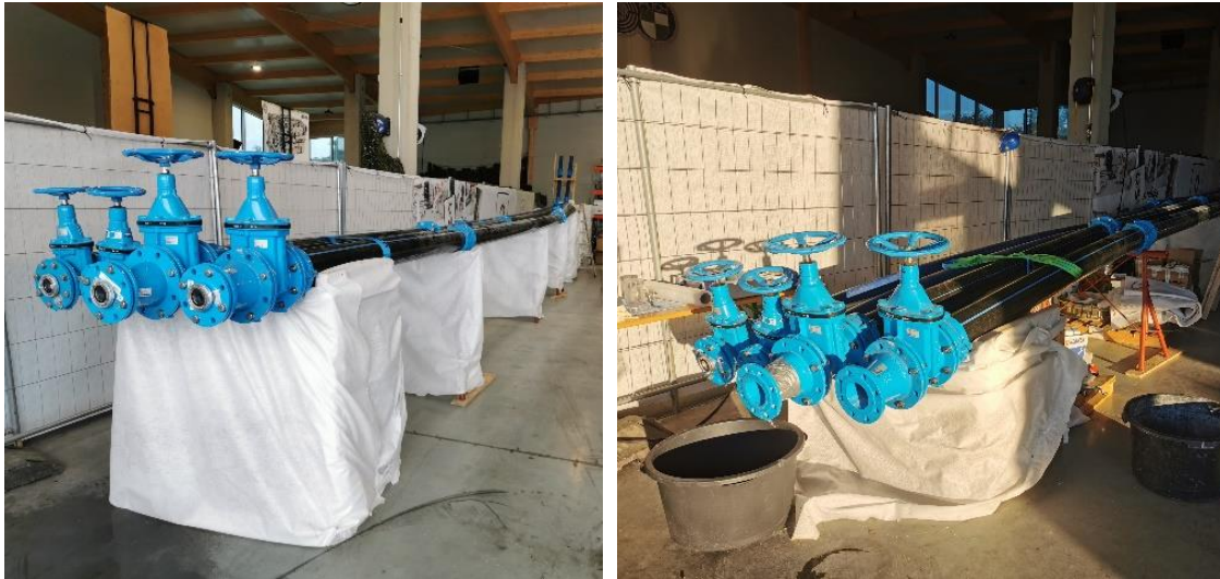
Abbildung 6-14: Vergleich des Gefälles der Leitungen bei ca. 1 % (linkes Foto) und bei ca. 5 % (rechtes Foto).
