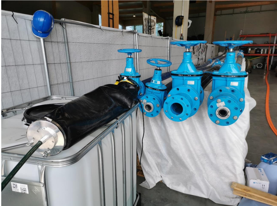
Abbildung 3-7: Montierte Schutzschleuse am Ende der Rohrleitung 1 während einer L.E.S.S.-UV-C-Desinfektion.
