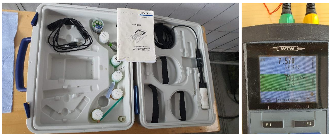
Abbildung 6-1: Multisonden-Messgerät der Fa. WTW vom Type Multi 3430 zur Messung der Temperatur, des pH-Wertes und der Leitfähigkeit (Fotos: Gruber).
