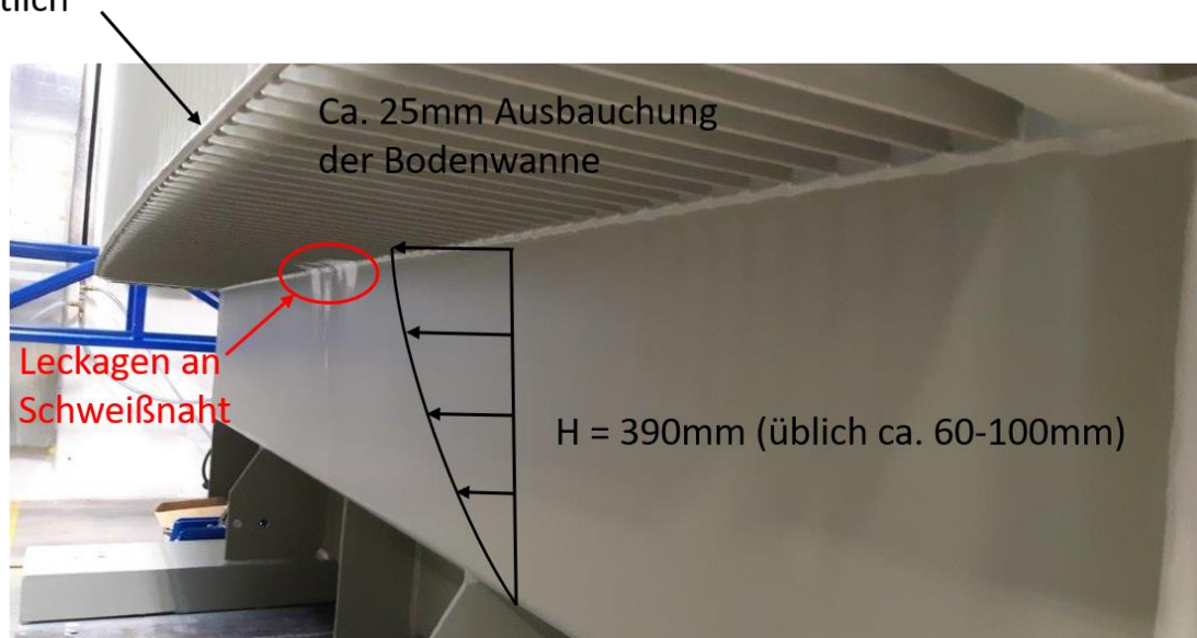
Abbildung 14: Deformation der Bodenwanne infolge des hydrostatischen Druckes und verformungsinduzierte Leckagen [1].
