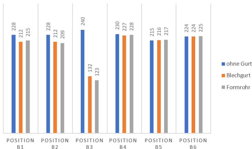
Abbildung 53: Vergleichsspannungen für die Bereiche A und B
