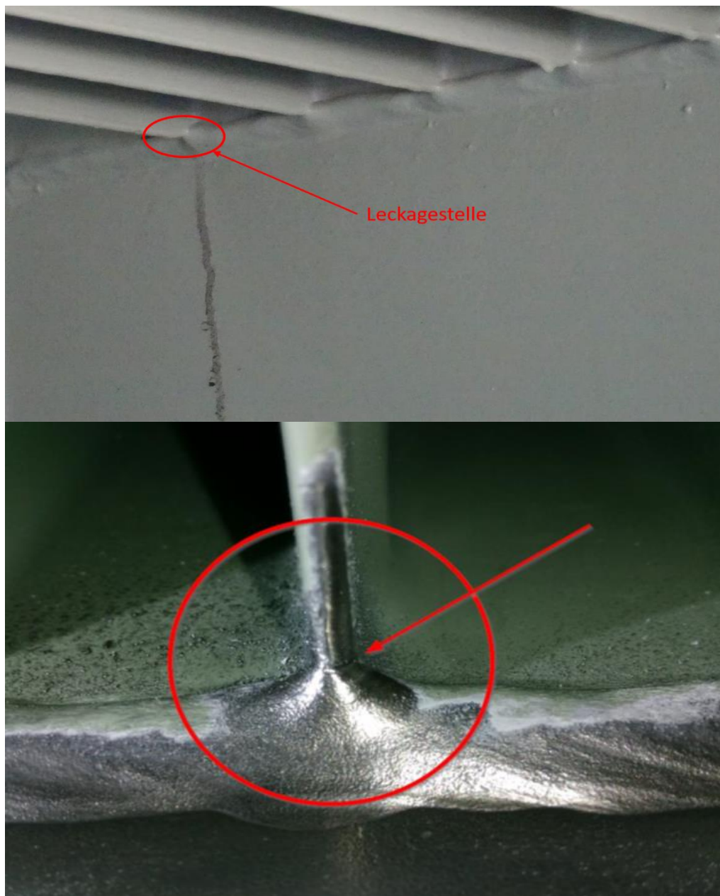
Abbildung 12: Leckagestelle an Wellwand-Bodenwanne Schweißnaht (oben), von Lack befreite Leckagestelle [1]
