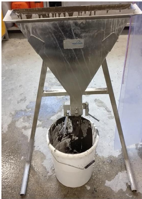
Abbildung 43: Trichterauslaufversuch
