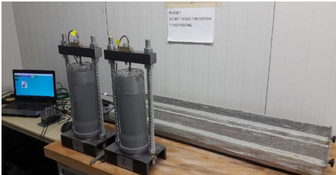
Abbildung 49: Vertikaler und horizontaler Schwindversuch
