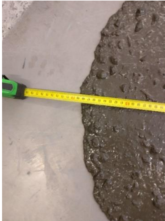
Abbildung 37 Randbereich des Setzfließmaßes zur Beurteilung der Gleichmäßigkeit der Mischung
