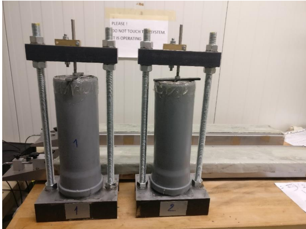
Abbildung 51: Vertikaler Schwindaufbau
