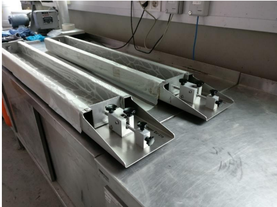
Abbildung 50: Detail des Stempels von horizontalem Schwindaufbau
