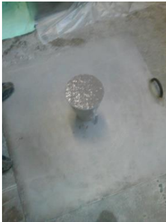
Abbildung 34: Bild gefüllter Setztrichter für Setzfließmaßversuch
