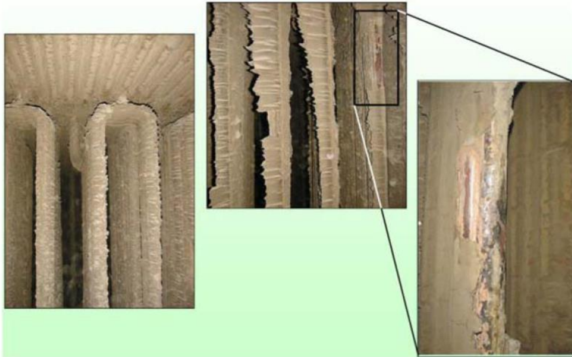
Abbildung 38: Ablagerungsbildung an der Oberfläche eines Speisewasservorwärmers (Vakkilainen 2017, S. 183)
