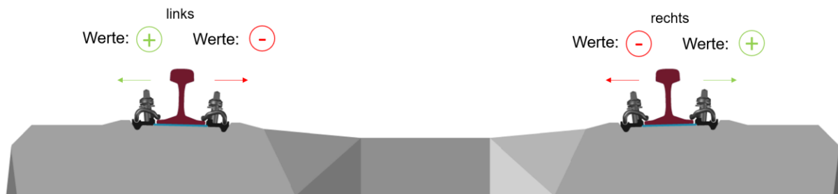
Abbildung 4-5: Vorzeichenkonvention der Lateralkraft
