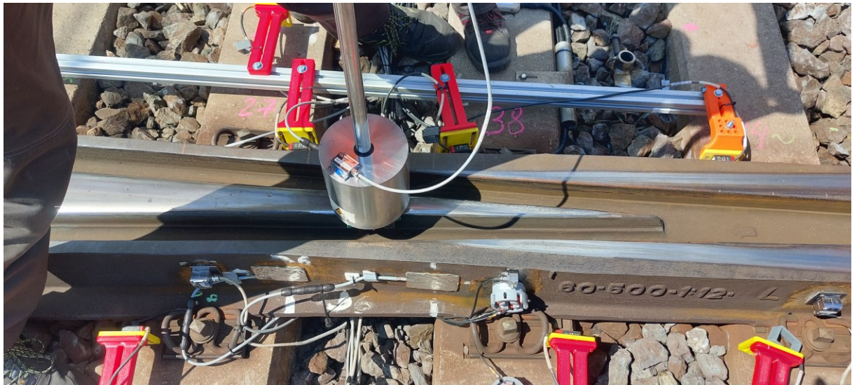
Abbildung 3-16: Beispielaufbau eines Fallgewichts mit Beschleunigungssensor
