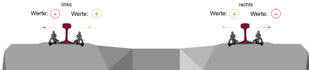
Abbildung 4-4: Vorzeichenkonvention des Einleitungspunktes der Vertikalkraft
