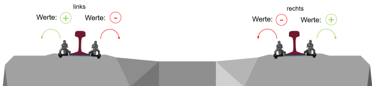
Abbildung 4-8: Vorzeichenkonvention von Schienenverkipfung
