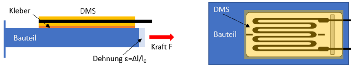
Abbildung 3-6: Schematische Darstellung DMS [23]
