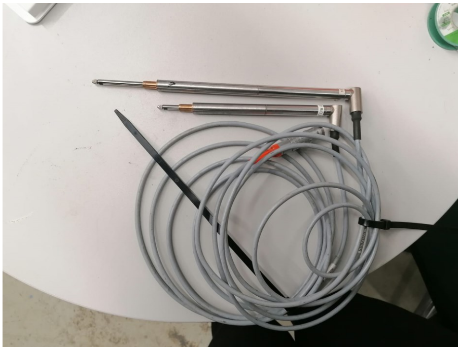
Abbildung 3-10: Induktiver Wegsensor [23]
