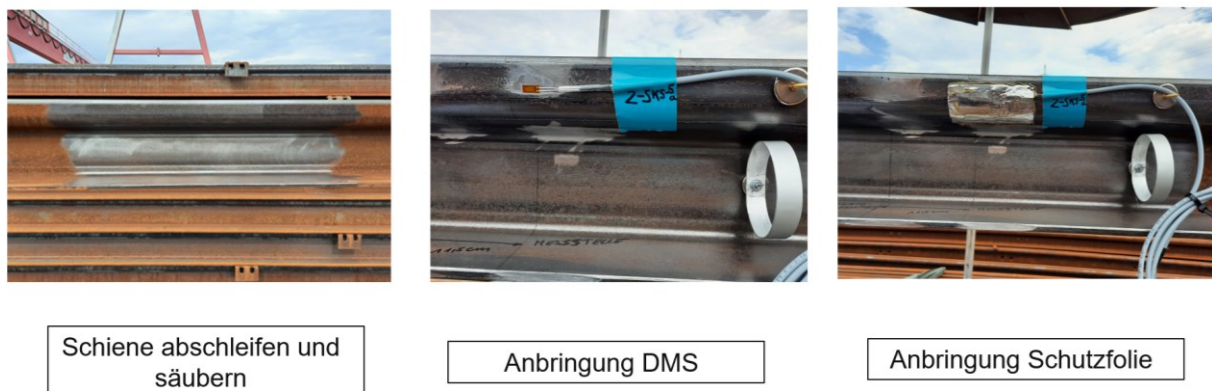
Abbildung 3-7: Schrittweises Anbringen eines DMS [23]
