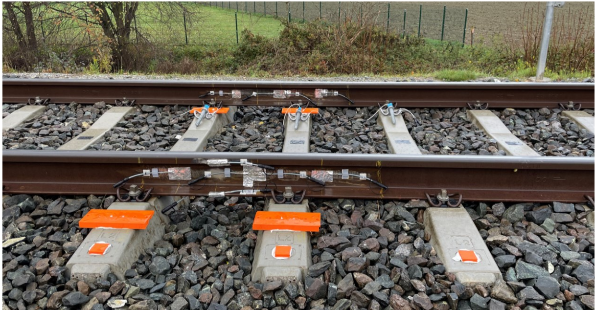
Abbildung 3-5: Messaufbau der (Scher-) DMS
