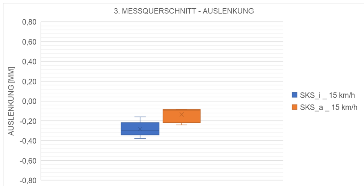
Abbildung 4-13: Auslenkung des 3. Messquerschnittes (1. Messung) [eigene Darstellung]
