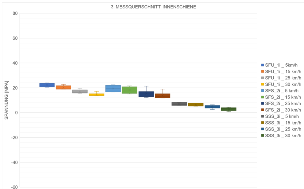
Abbildung 5-15: 3. Messquerschnitt Innenschiene - DMS Positionen im Fuß- und Stegbereich [eigene Darstellung]
