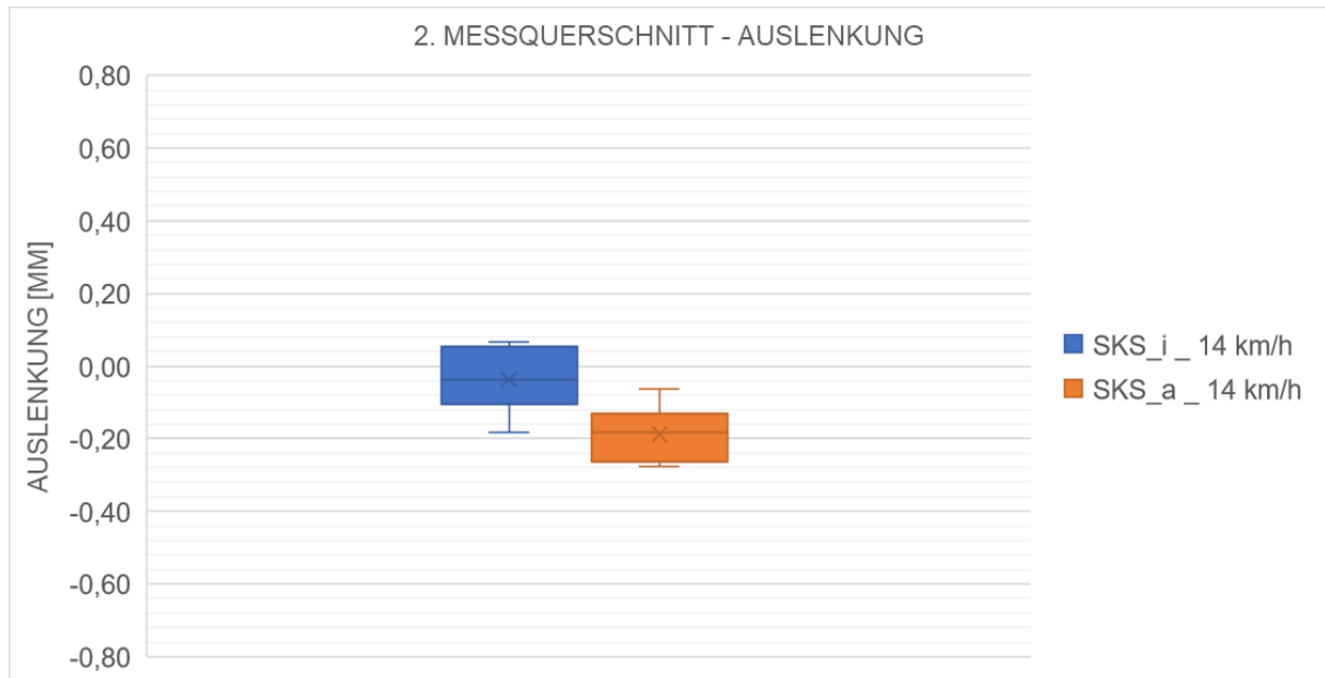
Abbildung 4-11: Auslenkung des 2. Messquerschnittes (1. Messung) [eigene Darstellung]
