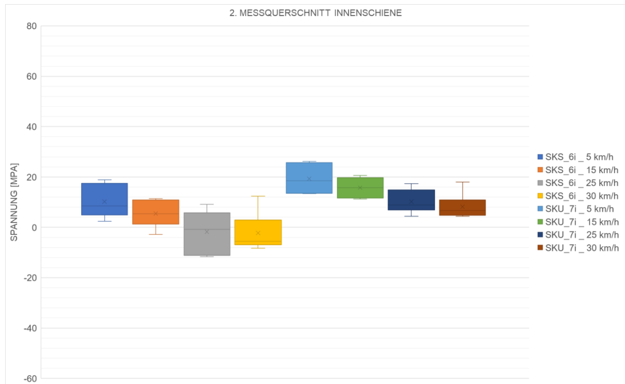
Abbildung 5-13: 2. Messquerschnitt Innenschiene - DMS Positionen auf der Fahrkopfseite [eigene Darstellung]
