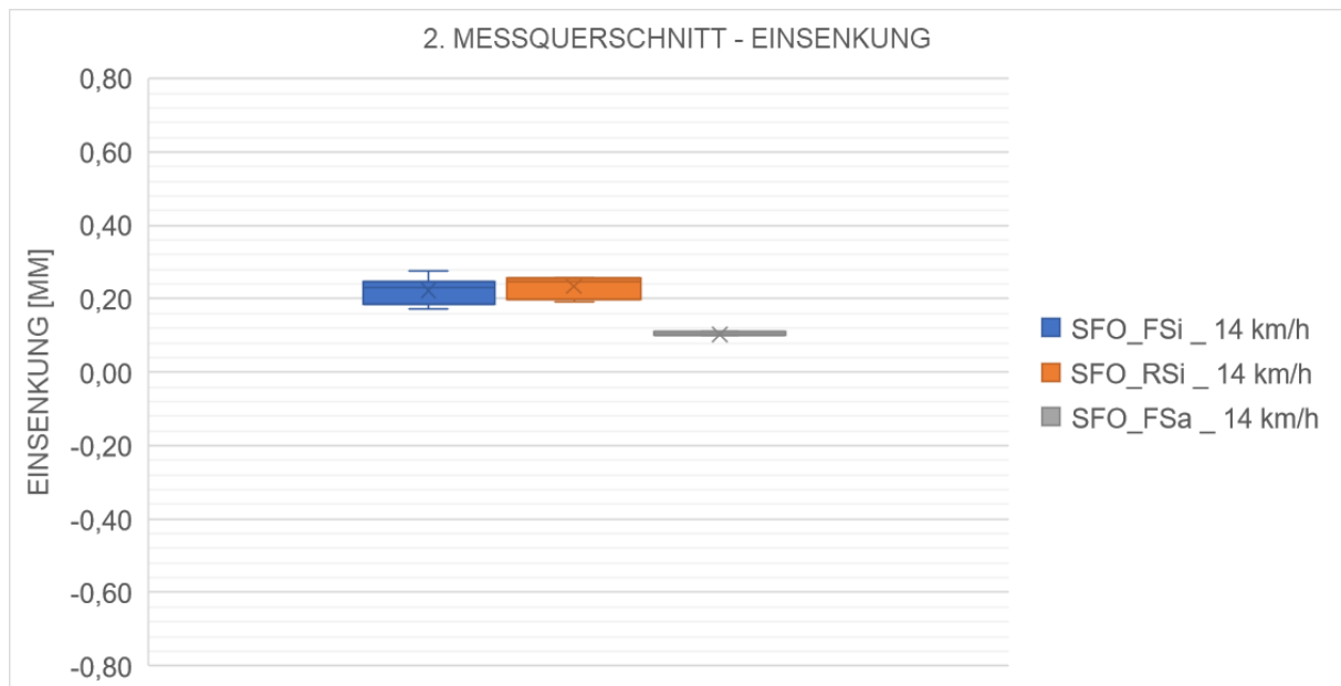
Abbildung 4-10: Eiseinkung des 2. Messquerschnittes (1. Messung) [eigene Darstellung]
