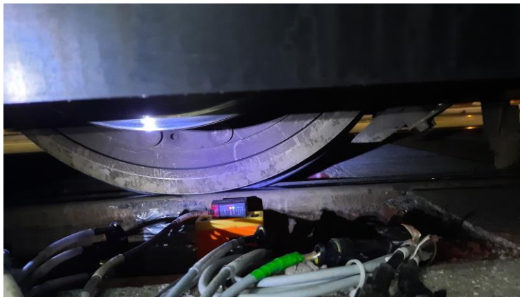
Abbildung 9-2: Statische Messung des ersten Losradpaares [eigene Aufnahme]
