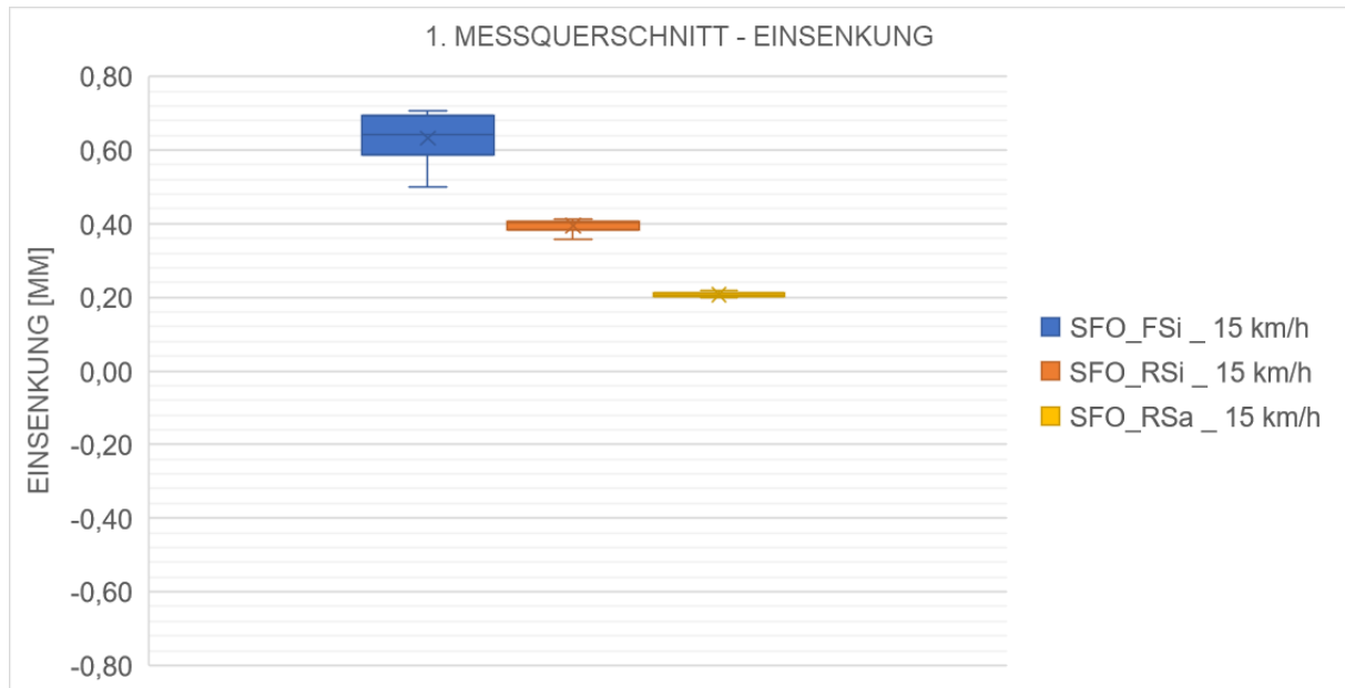
Abbildung 4-9: Eiseinkung des 1. Messquerschnittes (1. Messung) [eigene Darstellung]
