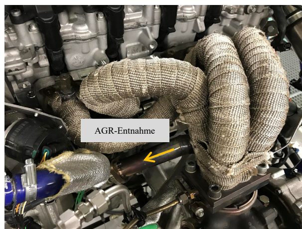
Abbildung 3-5: HD-AGR-Entnahmestelle
