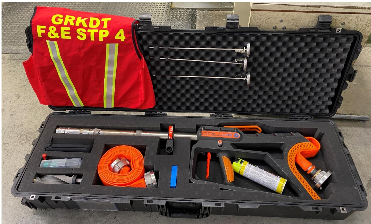
Abbildung 9: Ausrüstung des DRILL-X Set für die Feuerwehren bei Projektstart
