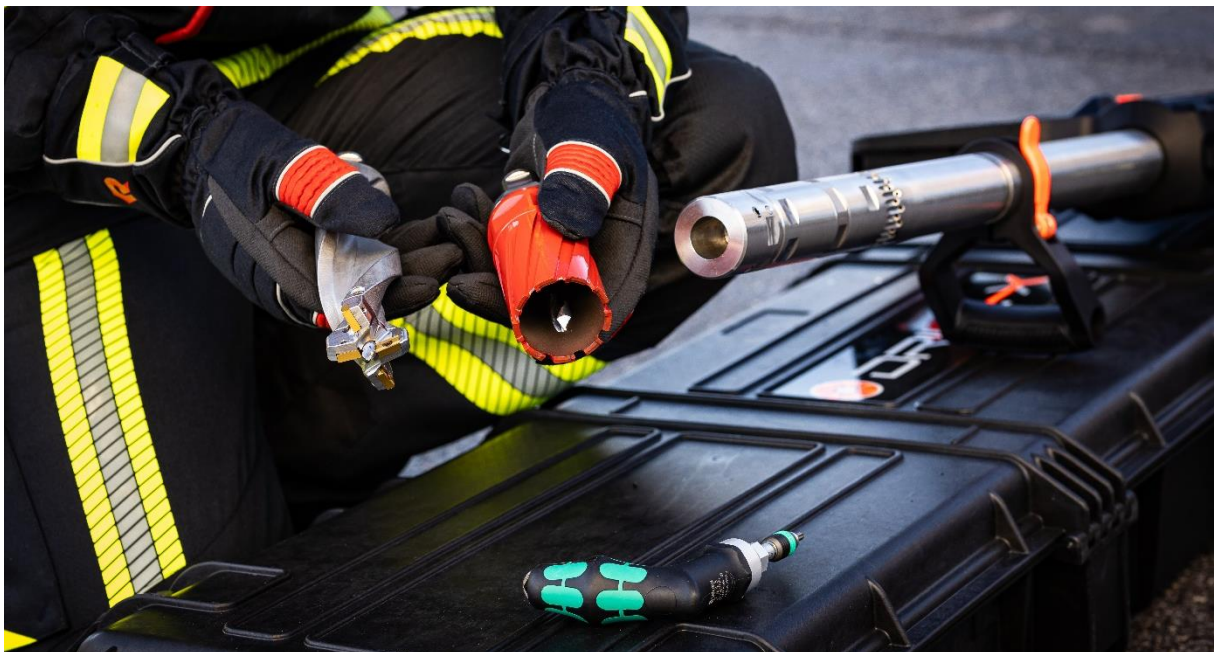
Abbildung 14: Vergleich von Universalbohrsystem und Metallbohrsystem [2]
