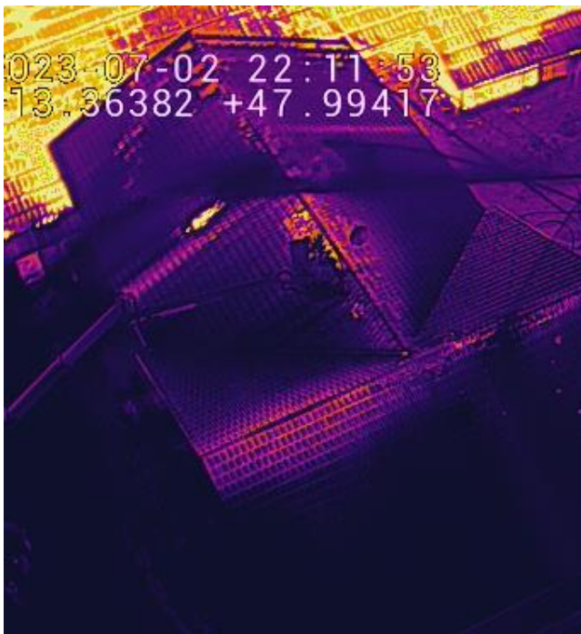
Abbildung 26: Drohnenaufnahme der Temperaturverteilung des Dachstuhlbrandes [13]
