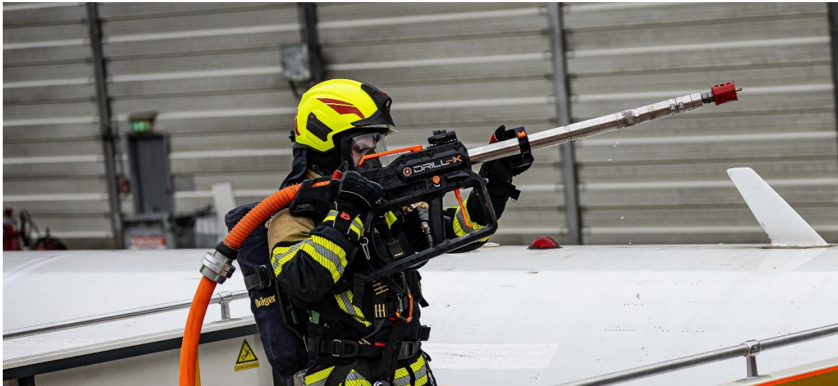
Abbildung 12: Prototyp der Metallbohrkrone [2]
