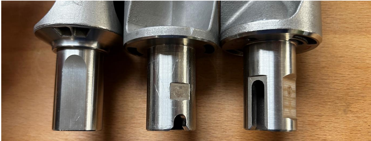
Abbildung 10: Spannverbindungen der Bohrsysteme, v.l.n.r. Revision 0, A, B
