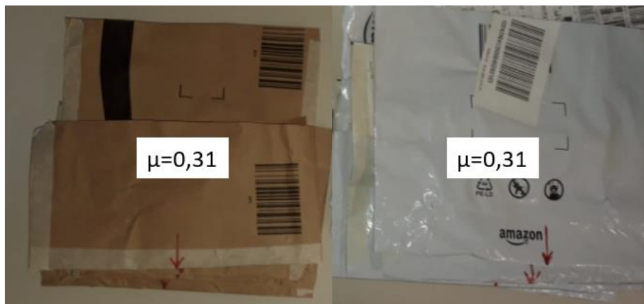
Abbildung 4.7: Proben mit selbem Reibwerten, aber aus verschiedenen Materialien
