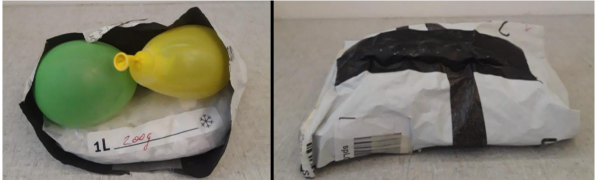
Abbildung 4.9.: Befüllung der Proben für die Faktorstufe mit großem projizierten Querschnitt
