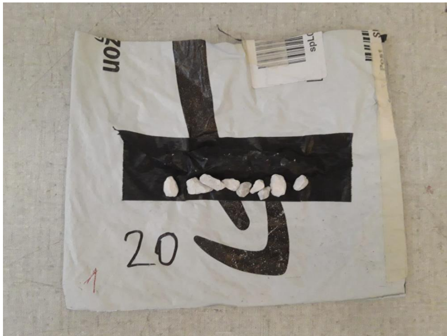
Abbildung 4.5.: Standardisieren des Verpackungsgewichtes auf 20g
